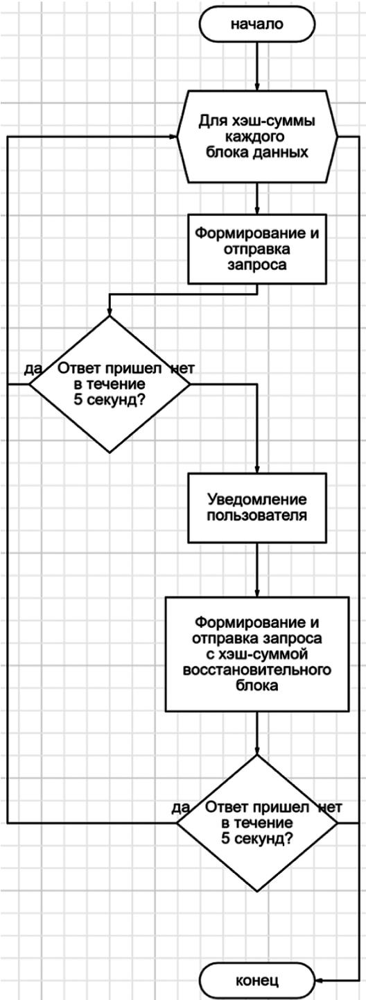
Рис. 4. Блок-схема процесса получения блоков клиентом при помощи алгоритма Base64 и десериализацией по стандарту JSON.
