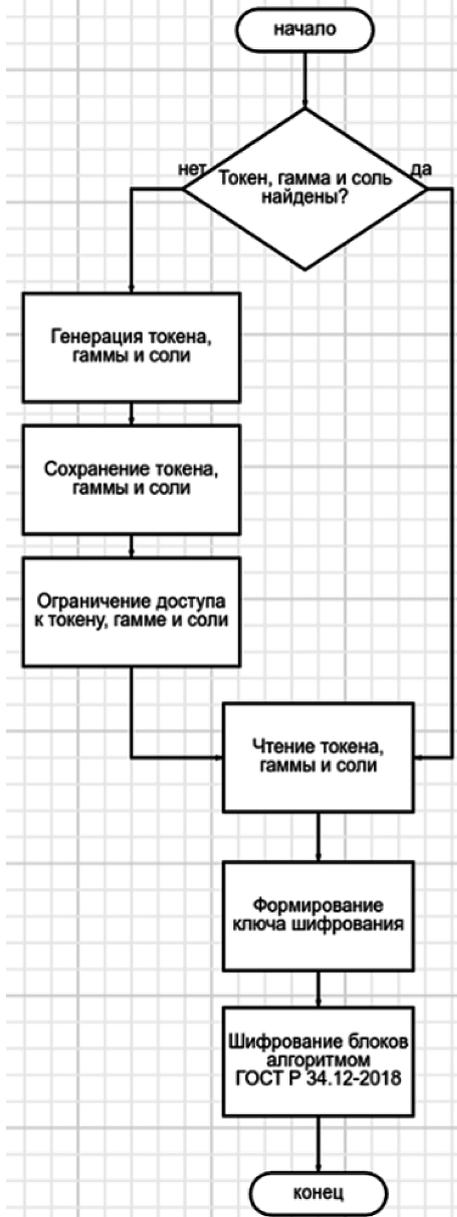
Рис. 1. Блок-схема процесса шифрования блоков данных
