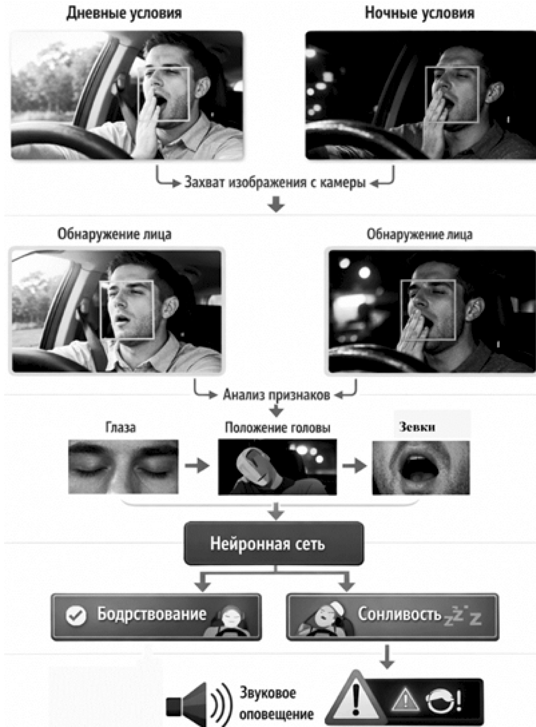
Рис. 1. Система мониторинга засыпания водителя
