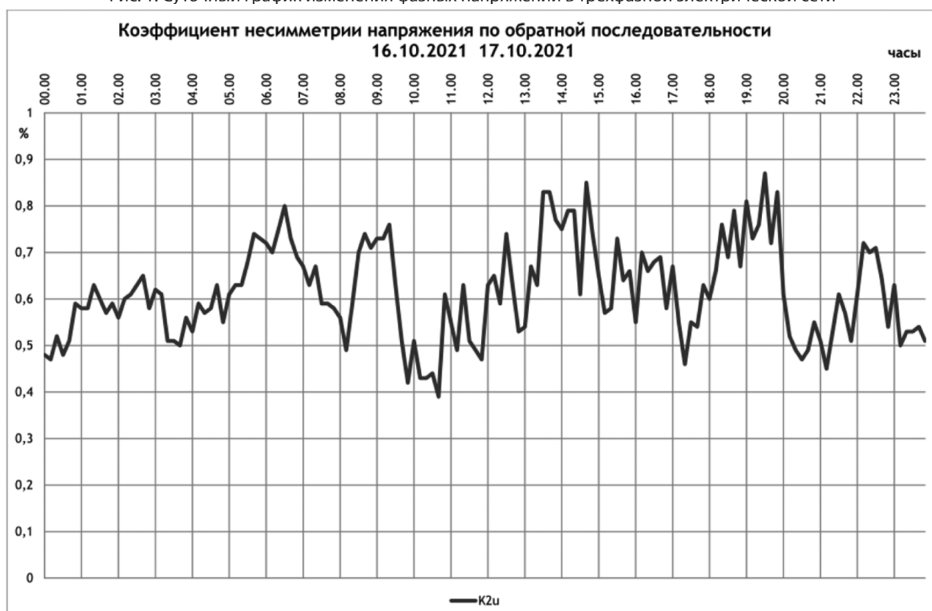
Рис. 2. Суточный график изменения коэффициента несимметрии напряжений по обратной последовательности в трехфазной электрической сети
