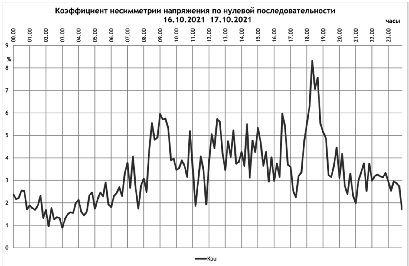
Рис. 3. Суточный график изменения коэффициента несимметрии напряжений по обратной последовательности в трехфазной электрической сети
