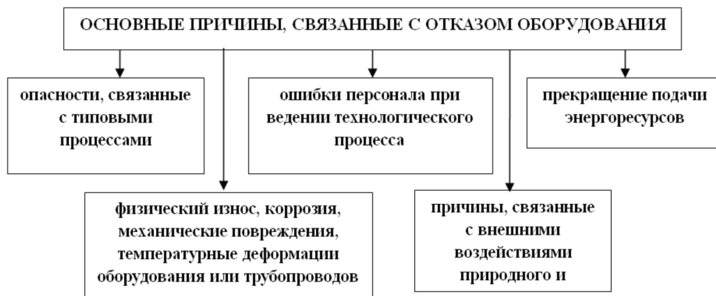
Рисунок 1. Основные причины, связанные с отказом оборудования газораспределительных пунктов.
