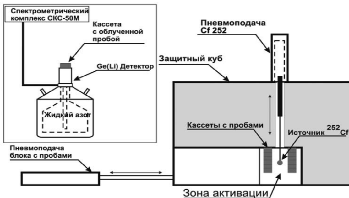
Рис. 1. Схема установки ИНАА с ампульным источником нейтронов на основе Cf-252
