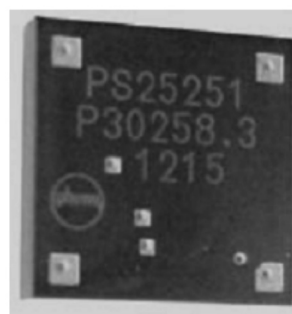
Рисунок 5. Датчики EPIC PS25251, PS25255 в корпусе QFN используемые в кардиологическом поясе.
