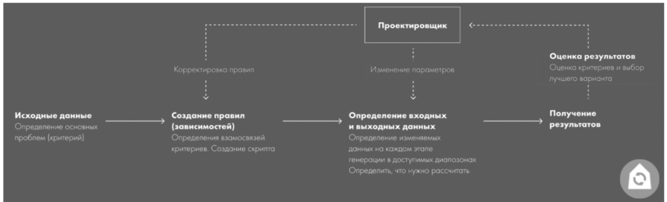
Рис. 9. Основная схема создания модели по принципу Generative Design [2]
