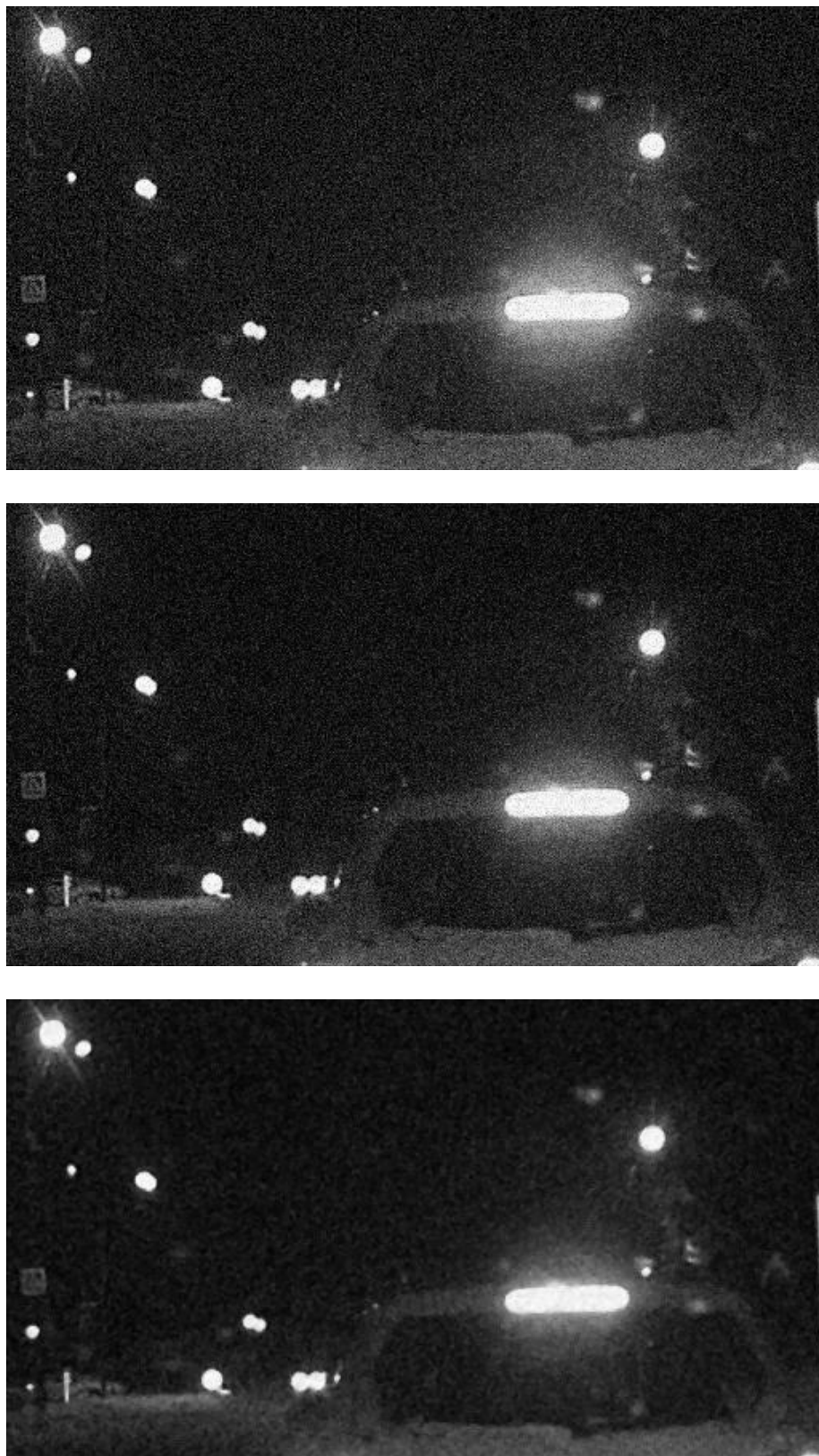
Рис. 3. (а) фрагмент исходного изображения с уровнем шума NL=14.7 , (б) фрагмент исходного изображения, переведенного в grayscale (с) фрагмент изображения после применения медианного шумоподавления, уровень шума NL=2.3
