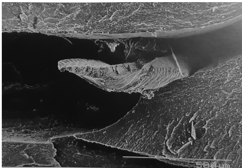
Рис. 1. При обработке канала медиального корня удаленного первого моляра нижней челюсти произошел перелом NiTi-инструмента (увеличение в 30 раз)
