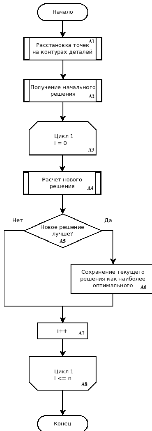
Рисунок 1. Схема алгоритма построения холостого хода режущего инструмента
