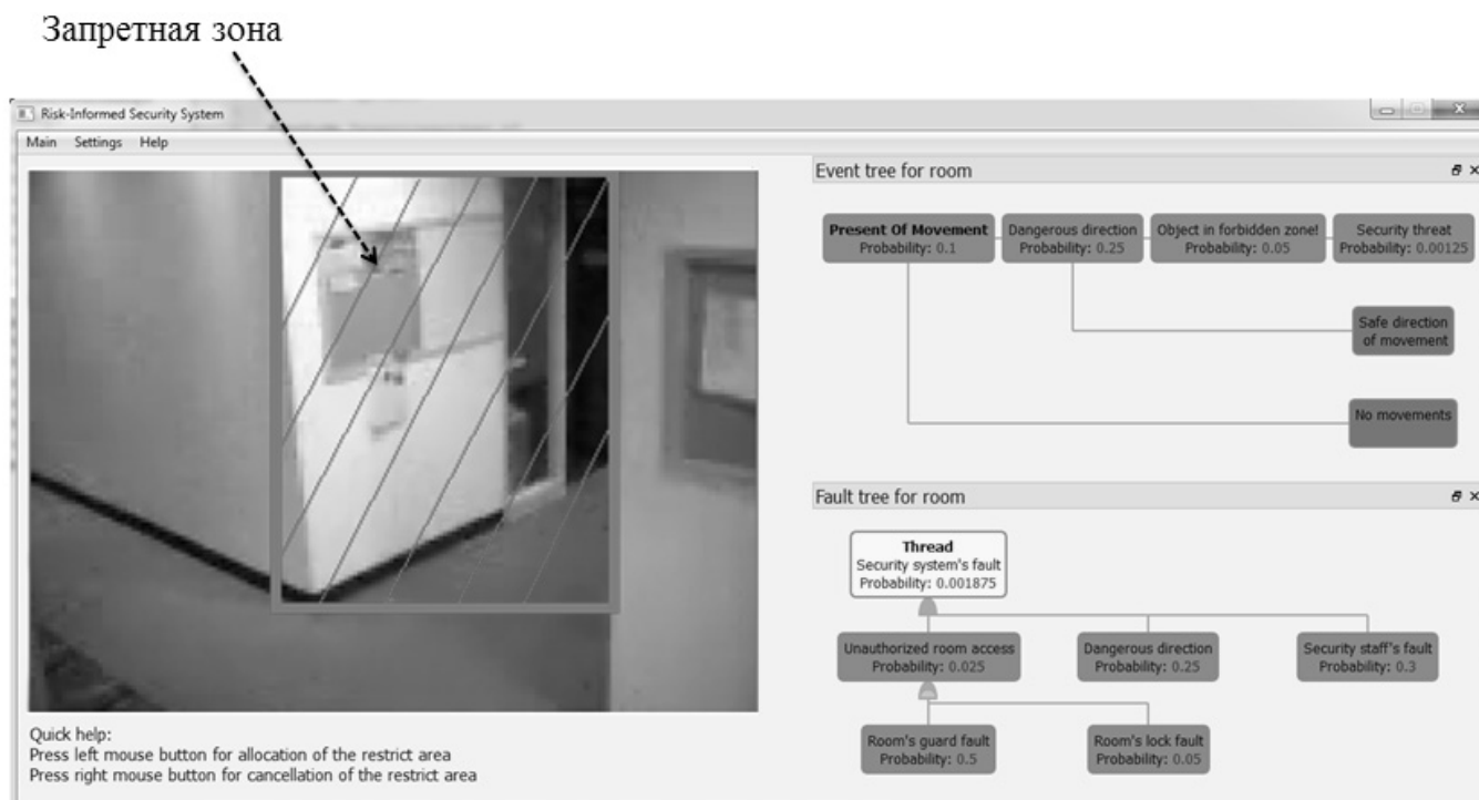
Рис. 2. Окно программы. Помещение (картинка с видеокamеры в реальном времени), «запретная» зона в помещении, дерево событий (сверху) и дерево отказов (снизу)
