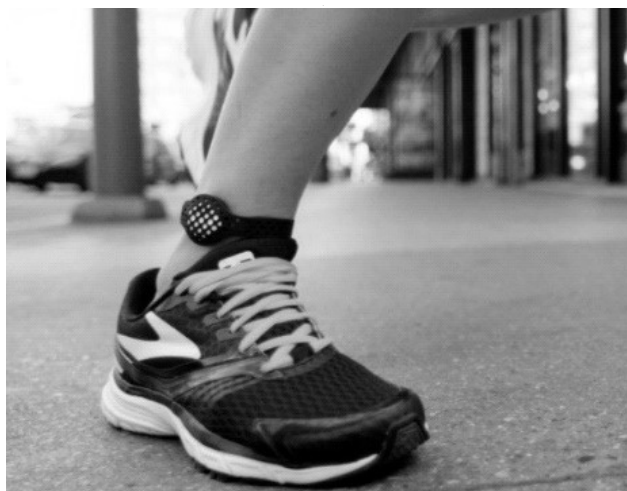
Рис. 5. Устройство Moov Now, содержащее девятиосевой датчик движения
