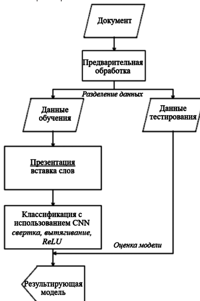
Рис. 1. Блок-схема нейросетевого классификатора (составлено автором)
