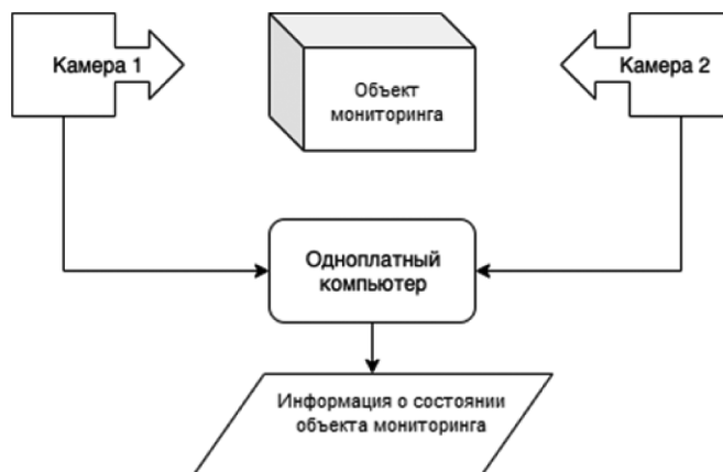
Рис. 3. Концептуальная схема работы экспериментальной модели мониторинга геометрических параметров исследуемого объекта
